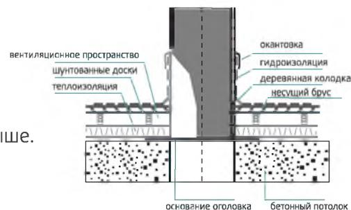
Рис. 4. Монтаж крышного перехода на косой крыше.
