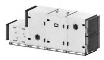
Корпус установок Alatau представляет собой бескаркасную панельную конструкцию, плотно состыкованную замковыми соединениями. Соединение панелей между собой осуществляется без применения профильных конструкций.
